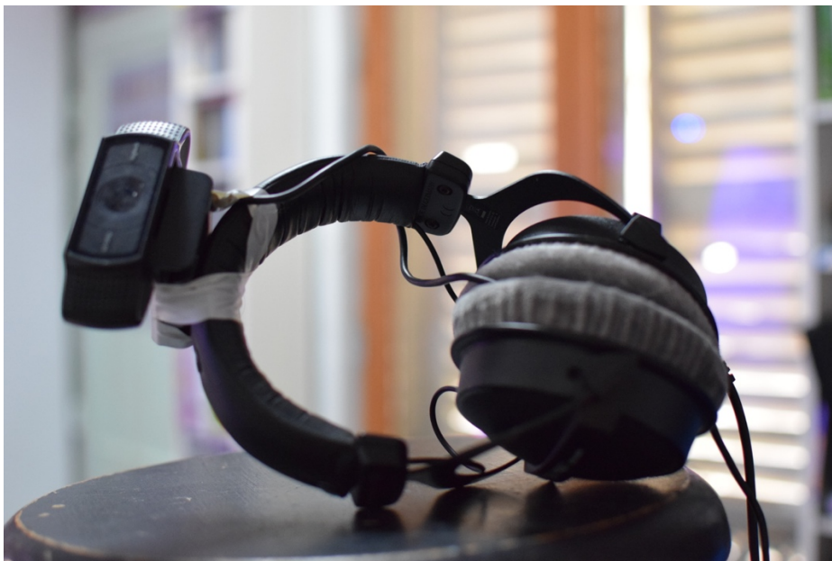
Casque muni d'une webcam pour interpréter le signal visuel
